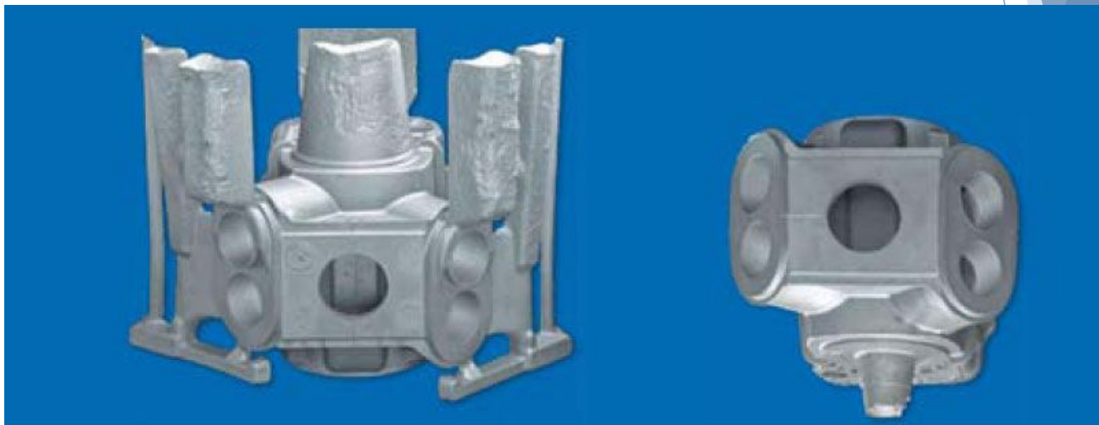
Фланец Сплав: GK-ALSi7MG - 4,7 кг
