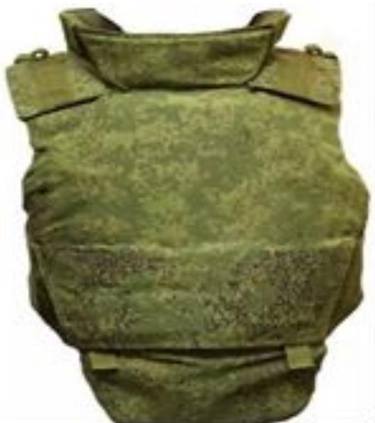
Бронежилет “6Б23-1” обеспечивает защиту от ударов холодного оружия и осколков, образующихся при разрыве гранат, мин и других боеприпасов (осколок массой 1 г на скорости 540 м/с, 50%). Защитные свойства бронежилета сохраняются в диапазоне температур от минус 50 до плюс 50° С, а так же после воздействия влаги (дождя, мокрого снега и т.д.). Защитная композиция совместно с вентиляционно-амортизирующей системой обеспечивает снижение запреградного (контузионного) воздействия до допустимых значений.
