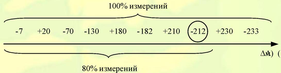
Определение максимальной ошибки измерений
