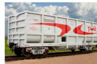
Полувагон 12-9828 (с глухим полом и нагрузкой на ось 27 т)
