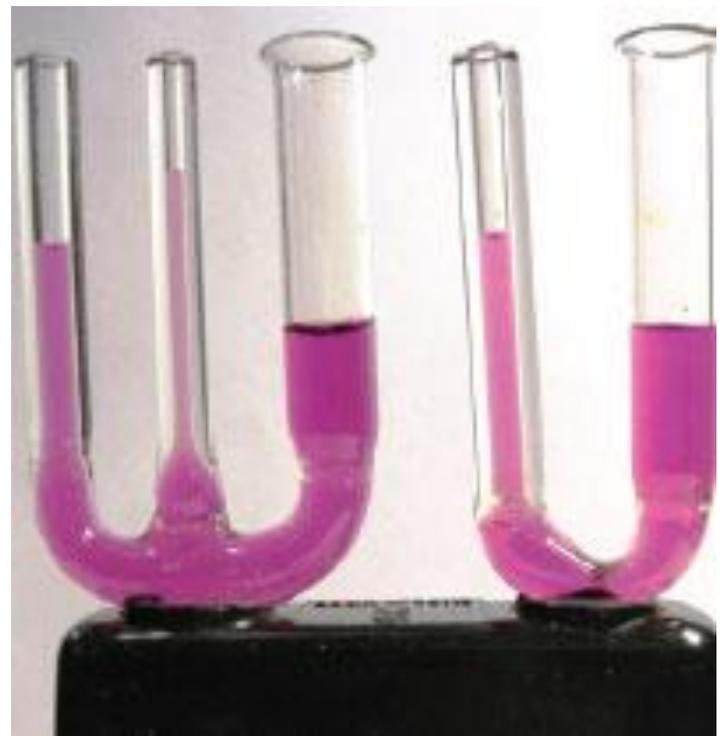
В поле тяжести (или сил инерции) поднятие жидкости происходит в случаях смачивания каналов жидкостями, например воды в стеклянных трубках, песке, грунте и т. п. Понижение жидкости происходит в трубках и каналах, не смачиваемых жидкостью, например ртуть в стеклянной трубке.
