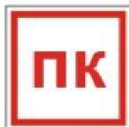
F12 ПОЖАРНЫЙ КРАН
