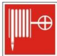
F02 ПОЖАРНЫЙ КРАН
