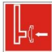
F08 ПОЖАРНЫЙ СУХОТРУБНЫЙ СТОЯК
