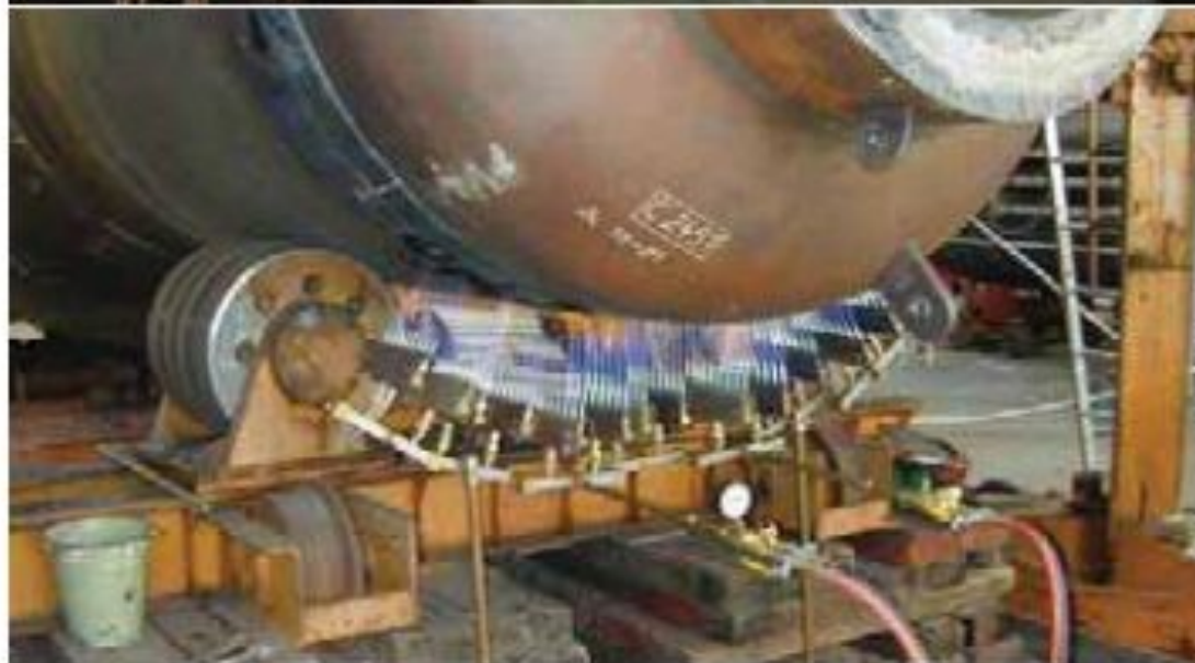
Рис 1. Подогрев при резке и сварке специальных сталей
