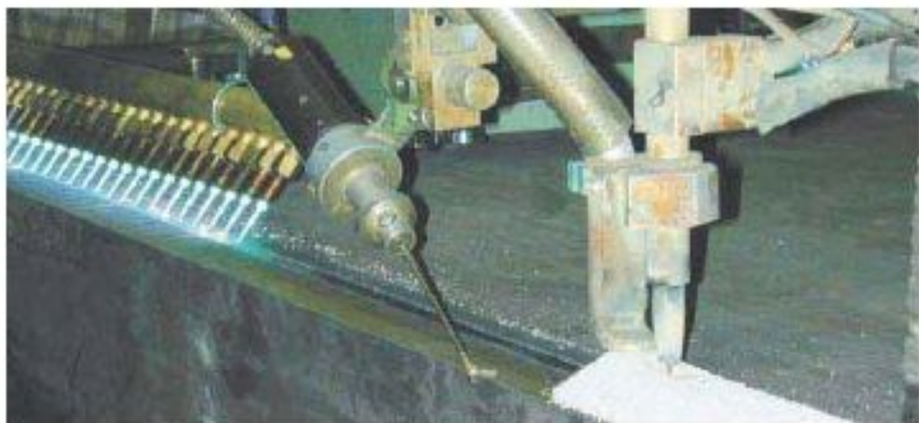
Рис 7. LINDOFLAMM® совмещенный предварительный подогрев совмещенный с сварочным процессом
