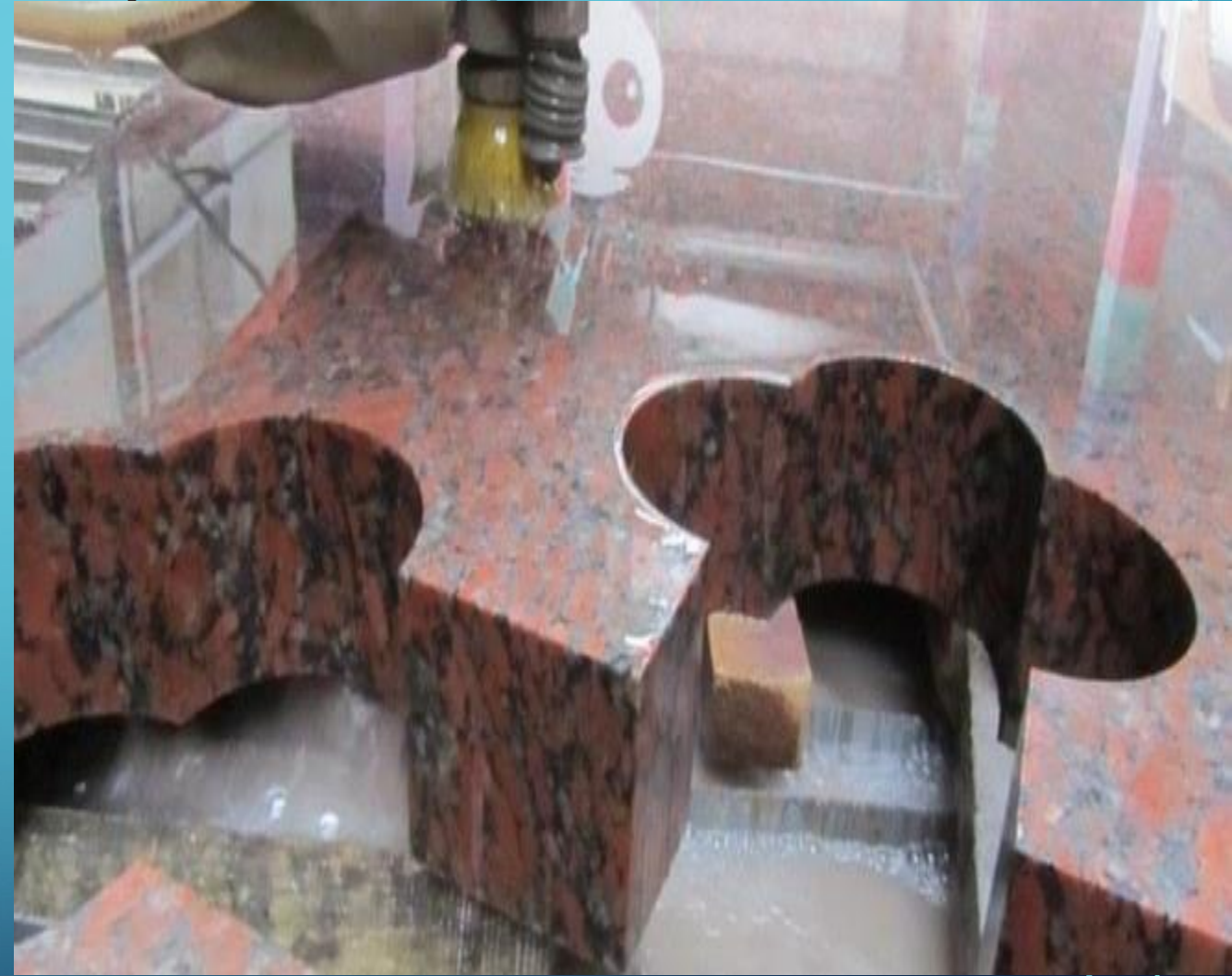
Гидроабразивная резка мрамора
