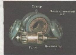
231. Асинхронный двигатель в разобранном виде
