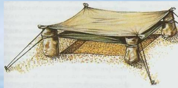
Укрытие, построенное при помощи ткани и песка
