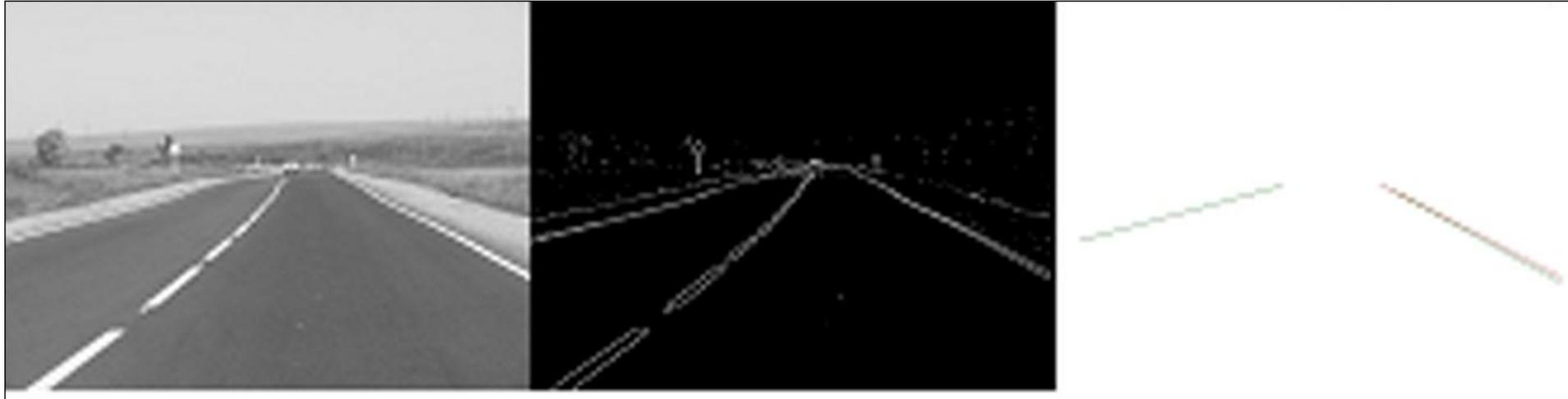
Следующая **основная задача** – **определение собственного положения МБЛА относительно выделенных линий**, в т.ч. **определение высоты полета МБЛА над поверхностью, на которой расположены выделенные прямые линии.**
