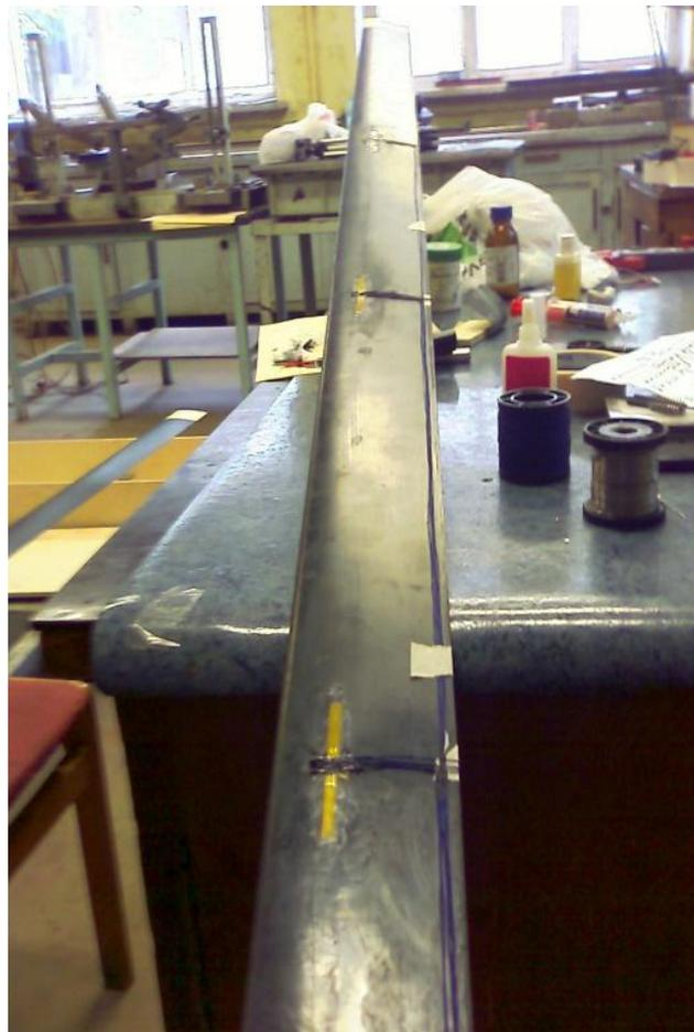
Расположение тензодатчиков на лопасти
