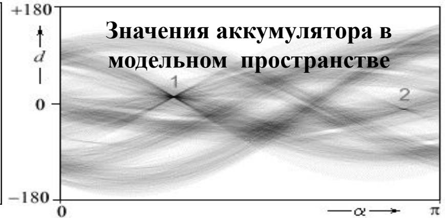
Сложность использования метода Хаффа в рассматриваемой прикладной задаче (выделения отрезков прямых в бортовом вычислителе) заключается в необходимости использования больших вычислительных мощностей, чтобы построить для каждой точки пространства данных прямую в модельном пространстве.
