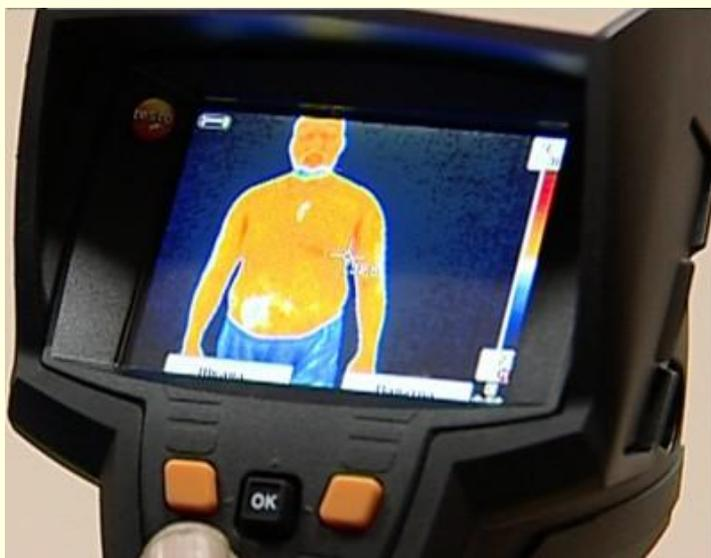
Тепловизор — устройство для наблюдения за распределением температуры исследуемой поверхности. Распределение температуры отображается на дисплее тепловизора как цветное поле, где определённой температуре соответствует определённый цвет.
