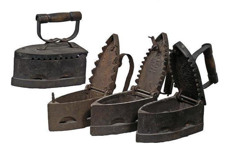
ВНУТРЬ КОРПУСА ЗАКЛАДЫВАЛИСЬ РАСКАЛЕННЫЕ УГЛИ. ЧТОБЫ СНОВА РАЗЖЕЧЬ ОСТЫВШИЕ УГЛИ УТЮГОМ РАЗМАХИВАЛИ ИЗ СТОРОНЫ В СТОРОНУ. ОНИ БЫЛИ ОЧЕНЬ ТЯЖЁЛЫМИ. УГОЛЬНЫЕ УТЮГИ ВЫПУСКАЛИСЬ ВПЛОТЬ ДО 1960 ГОДА.
