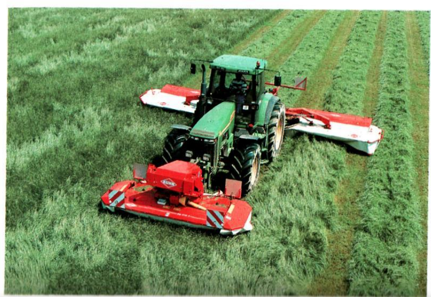
Рис. 1. Скашивание с плющением комбинированной косилкой- плющилкой FC 813/ FC 883
