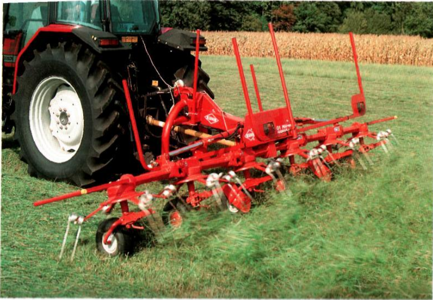
Рис. 2. Ворошение широкозахватной навесной ворошилкой GF
