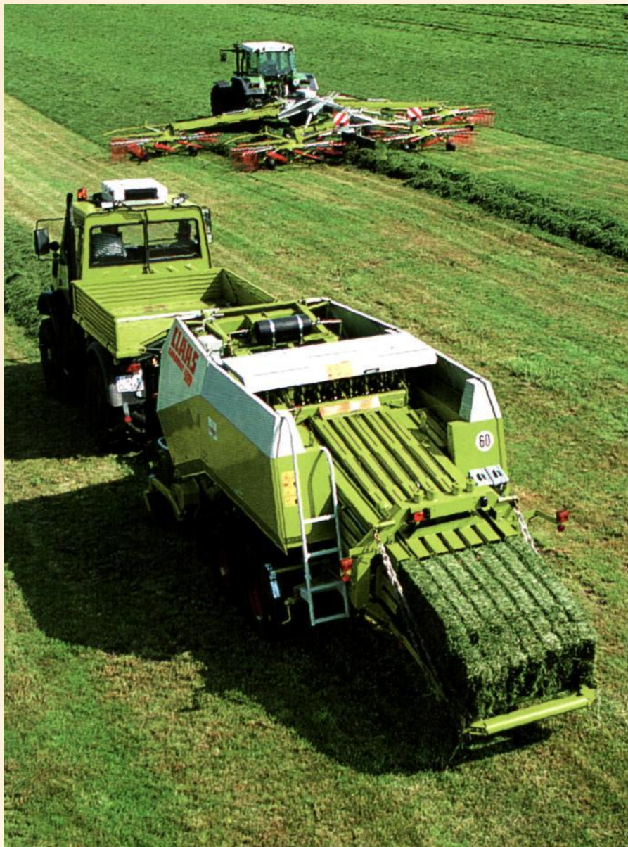
Рис. 4. Прессование сена в прямоугольные тюки пресс-подборщиком QUADRANT
