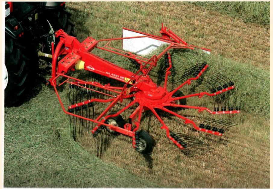
Рис. 3. Стребание в валки навесным валкообразователем GA
