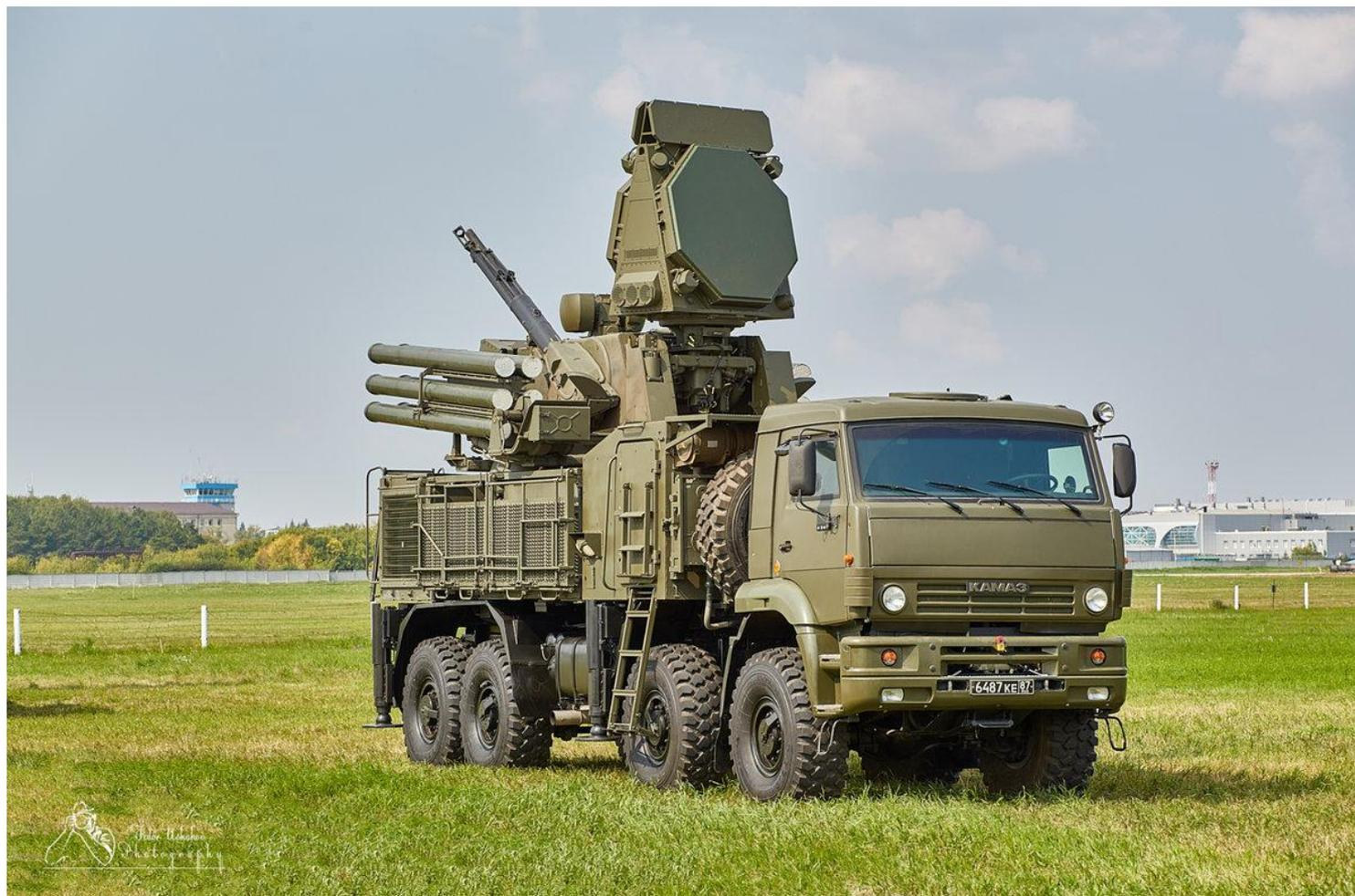
Комплекс "Панцирь-С1" (образец 1995 г.) оснащен 12 ЗУР 9М335, внешне и по компоновке похожими на ракеты 9М311 ЗРПК "Тунгуска" (дальность пуска возросла до 12 км, высота поражаемых целей - до 8 км)
