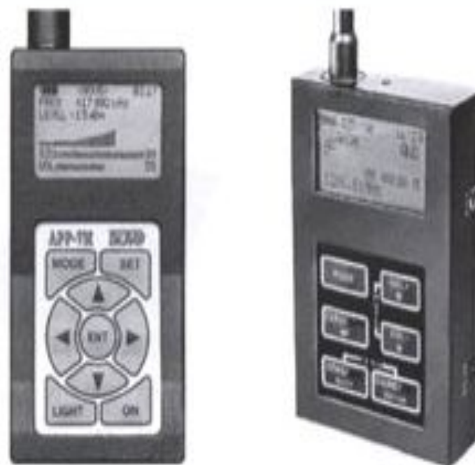
а б Рис. 7. Индикаторы поля: АПП-7М (а) и ST-007 (б)
