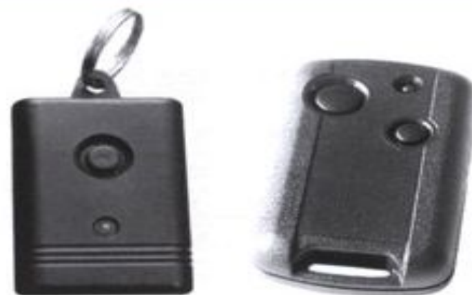
Рис. 13. Индикаторы поля, встроенные в брелоки: «Блик» (а) и «Сигнал-6» (б)
