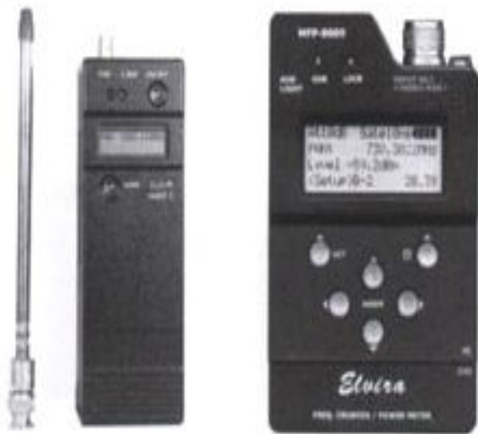
а б Рис. 6. Индикаторы поля: РИЧ-3 (а) и РИЧ-8 (б)
