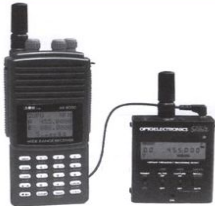
Рис. 10. Подключение сканирующего приемника к радиочастотомеру Scout
