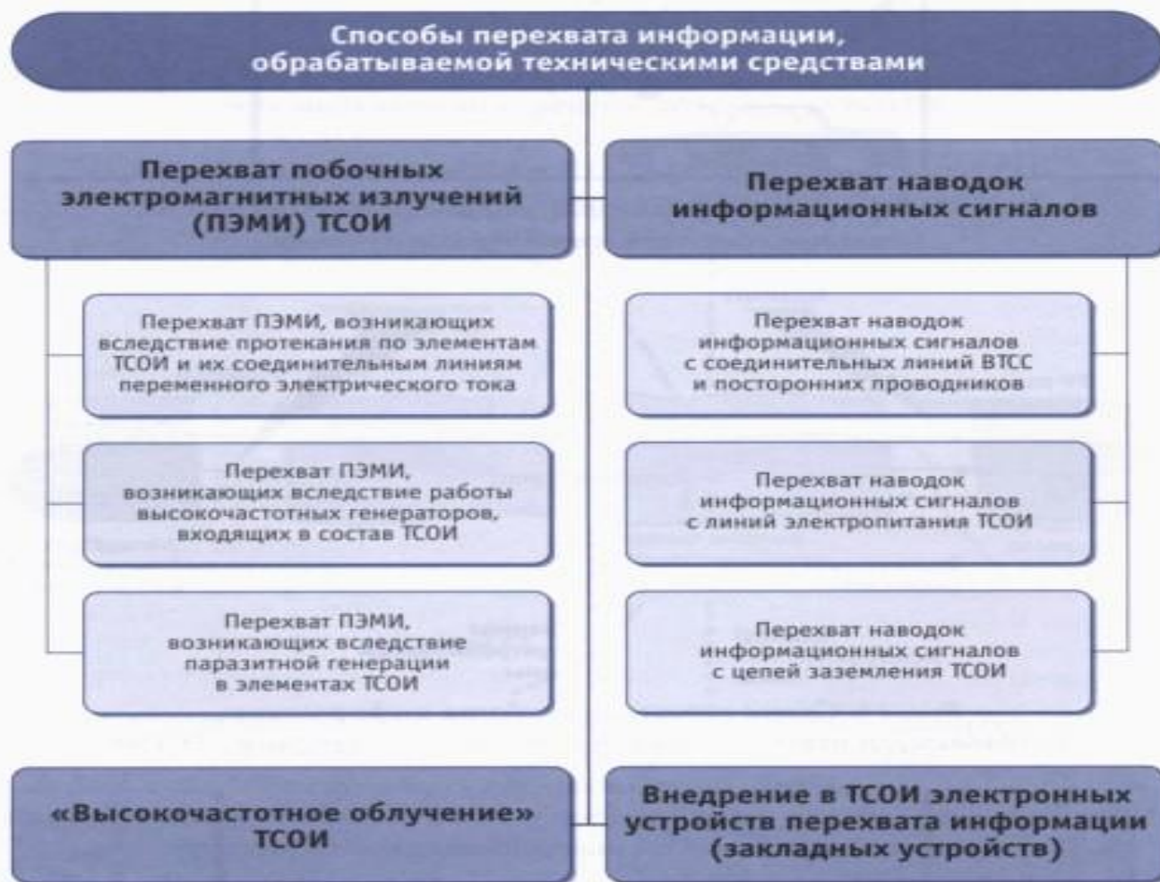
Рис. 17. Классификация способов перехвата информации, обрабатываемой техническими средствами
