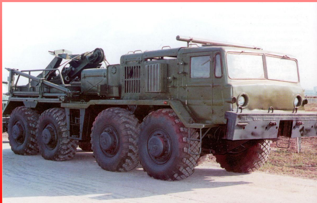
Тяжелый колёсный эвакуационный тягач КЭТ-Т (ТК-7)
