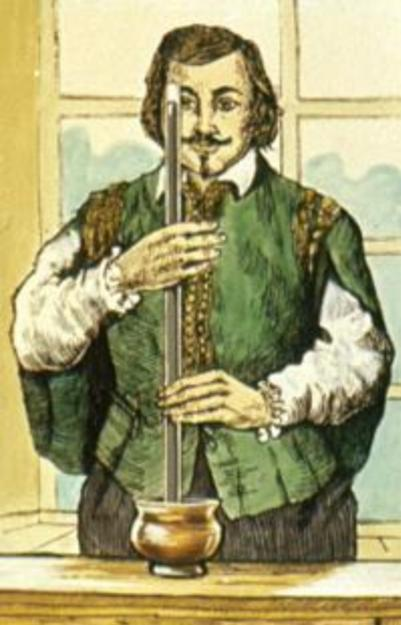
Опыты с более тяжелой жидкостью - ртутью, предпринятые в 1647г. Торричелли, привели к открытию атмосферного давления, которое равно давлению столба ртути в трубке:  $P_{атм} = P_{рт}$
