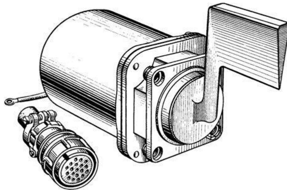
Рис.20. Датчик углов атаки ДУА
