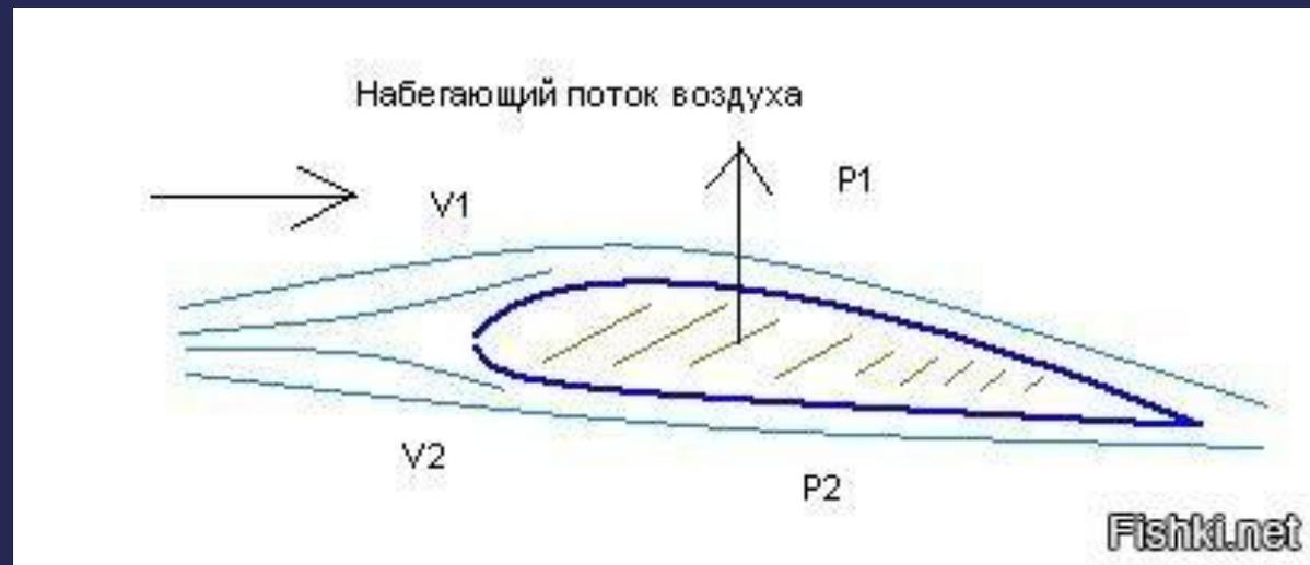
ПОДЪЕМНАЯ СИЛА КРЫЛА САМОЛЕТА
