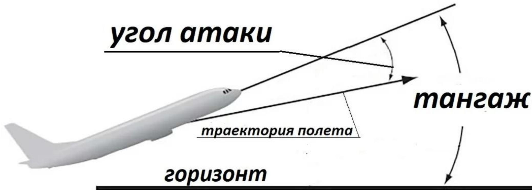
**Угол атаки** – угол между вектором воздушной скорости и продольной осью самолёта
