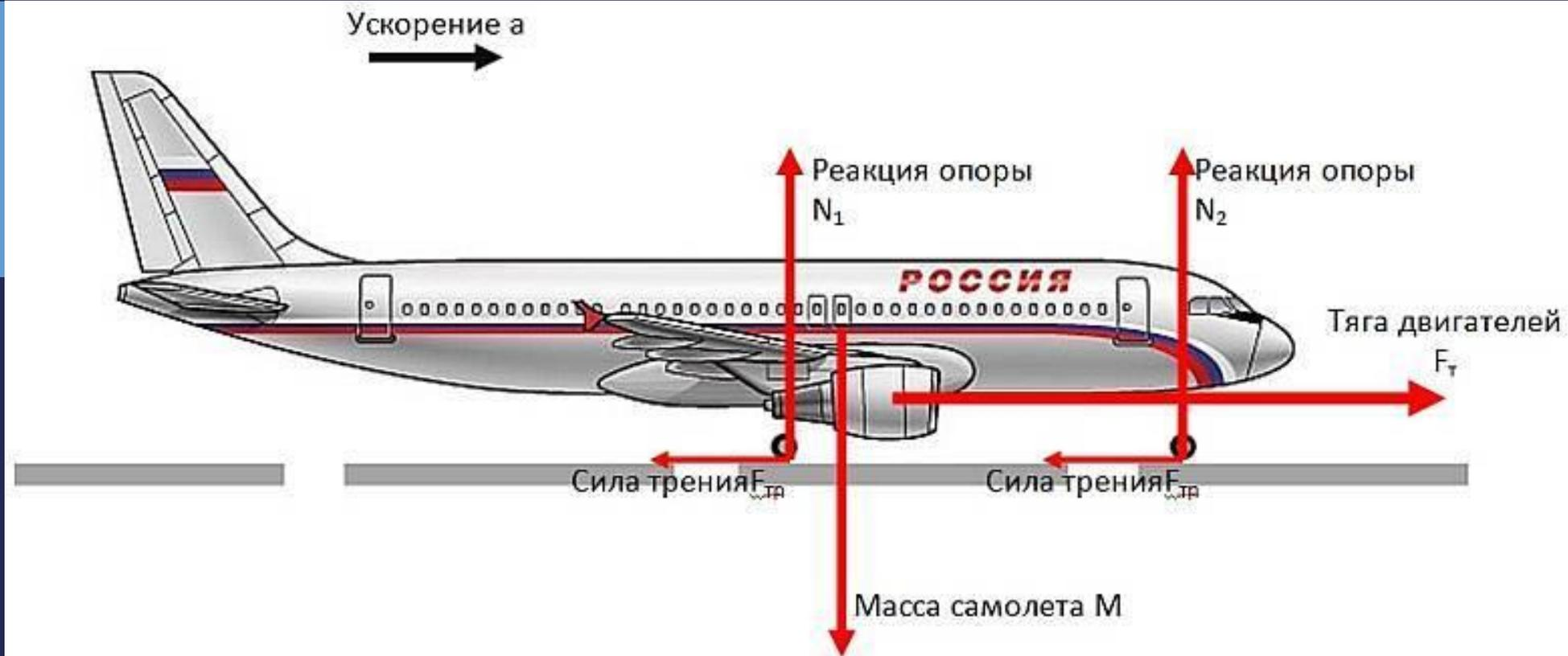
Какие силы действуют на самолет по оси X, которая важна нам для взлета? Используем второй закон Ньютона:
