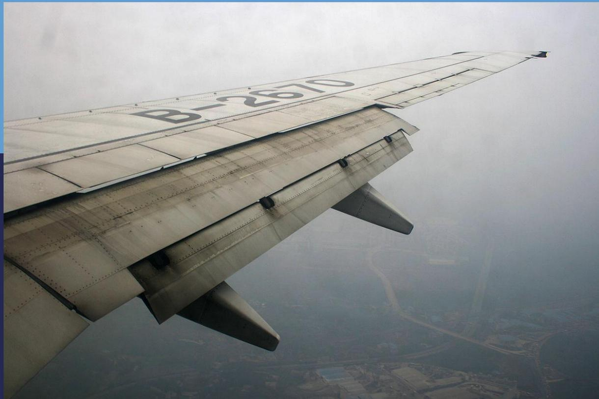
Принцип работы закрылков заключается в том, что при их выпуске увеличивается кривизна профиля и площадь поверхности крыла, следовательно, увеличивается и несущая способность крыла, которая позволяет самолетам лететь без сваливания при меньшей скорости.
