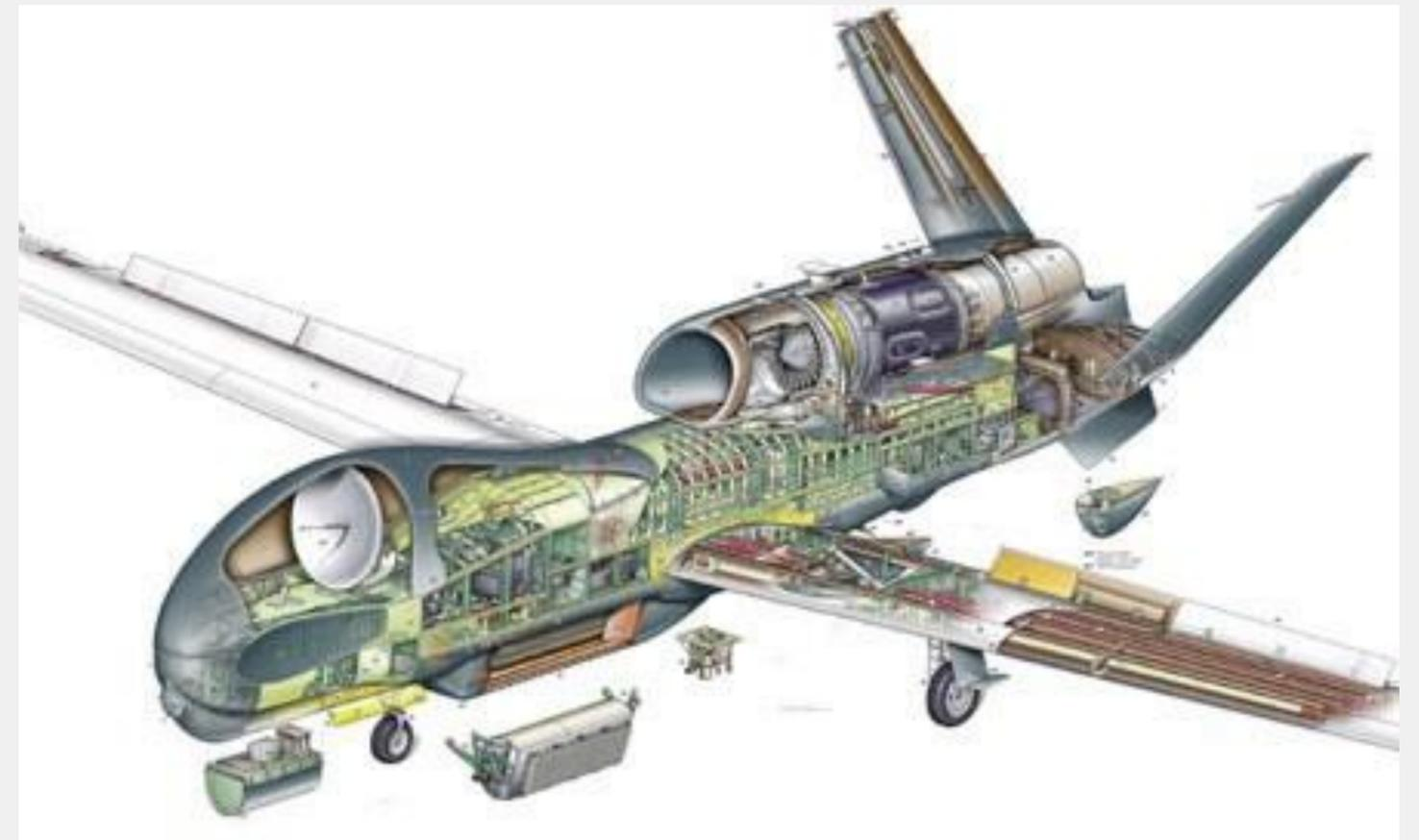
Длина 13,5 м, размах крыльев 35 м, высота до 18 км, нагрузка 900 кг, взлетная масса 15 т, максимальная скорость 640 км/ч, длительность полета до 30 ч. Силовая установка – ТРД тягой 34,5 кН.
