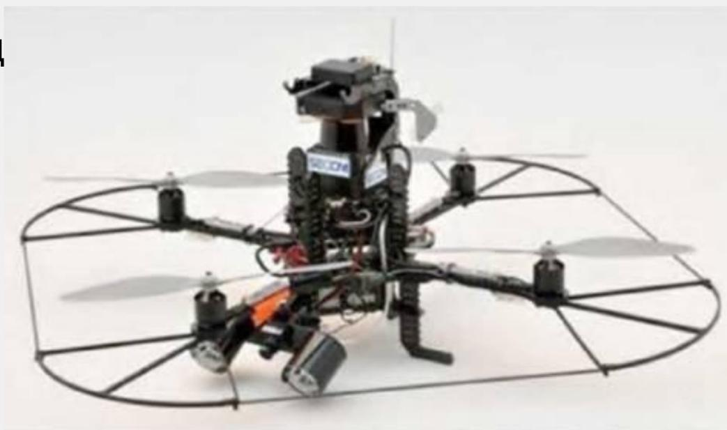
Квадрокоптер с защитой пропеллеров (вверху – GPS- модуль)
