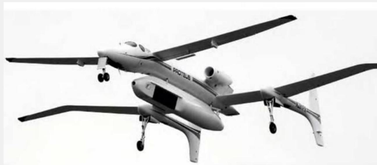
Длина 17,1 м, размах крыльев 28 м, высота до 16 км, нагрузка 3,2 т, взлетная масса 5,6 т, максимальная скорость 520 км/ч, длительность полета до 18 ч.
