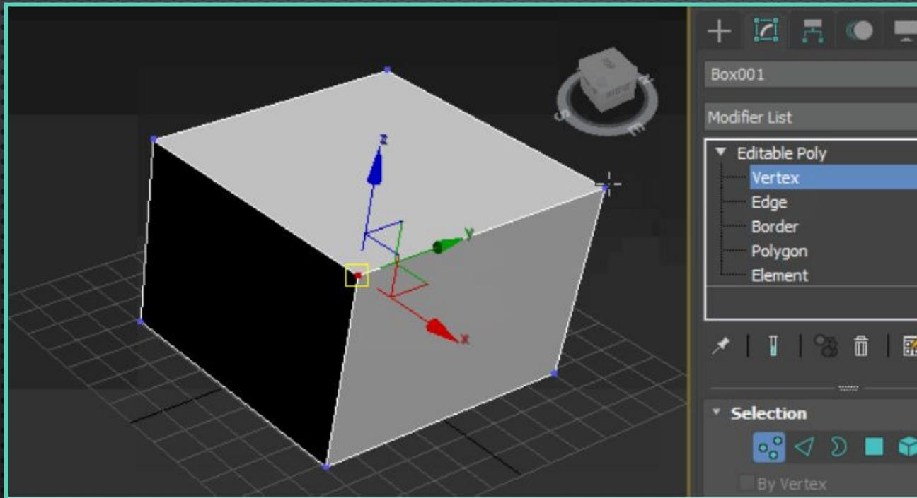
Vertex (Вершина) — это одномерный объект (точка) в пространстве. Если соединить, например, две вершины, получится ребро.
