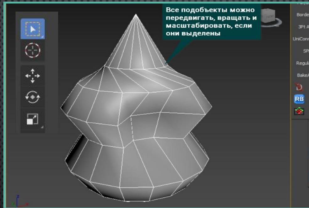
Точкой, ребром и целым полигоном можно управлять с помощью стандартных инструментов: выделение, передвижение, вращение и масштабирование.
