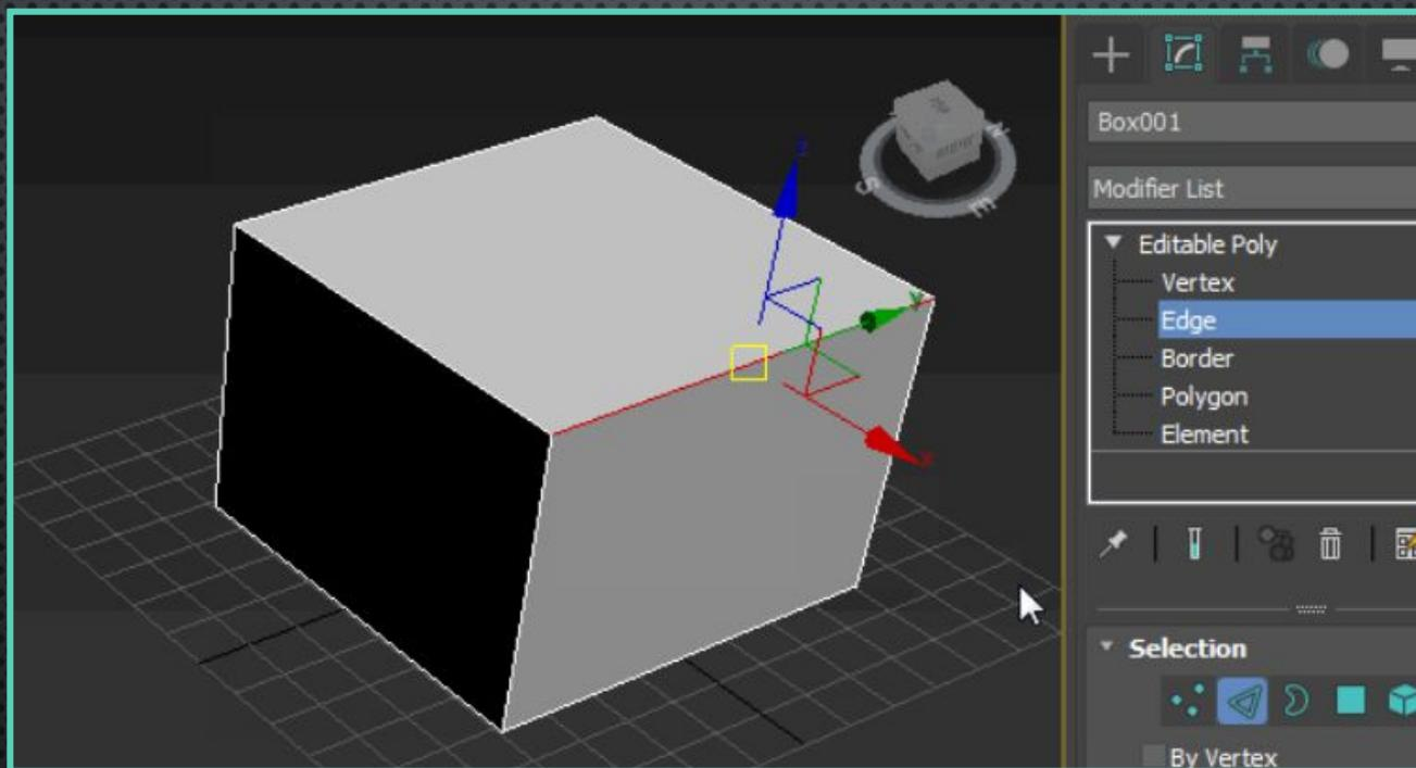
Ребро (Edge) — это двумерный объект, который определяется двумя вершинами и представляет собой линию. Три ребра и более образуют многоугольник.
