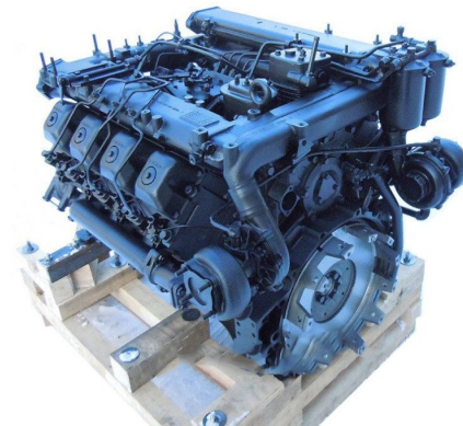
Двигатель грузового автомобиля, V- образный, восьмицилиндровый, рабочий объем двигателя, л
