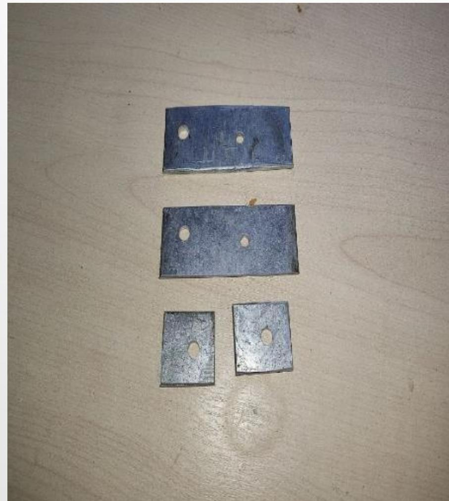
**Шаг 5. Серьги делаем из алюминиевой пластины с толщиной 2мм, и просверливаем оси**
