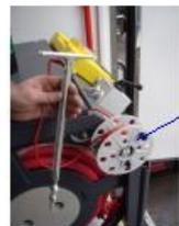
Барaban с кабелем вспомогательного заземления и штырем
