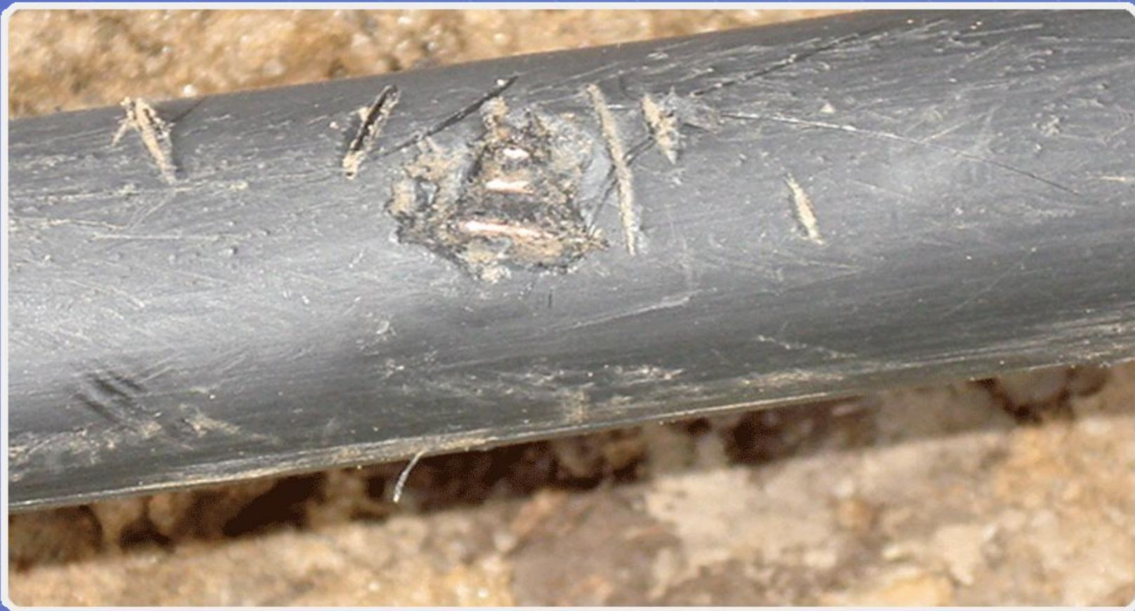
*Повреждение оболочки — следствие небрежной прокладки кабеля*
