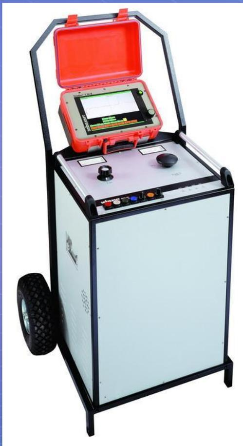
Surgeflex 32 является переносной установкой для испытания и определения места повреждения в силовых кабелях и в кабелях управления. С испытательным и импульсным напряжением до 32 кВ установку SPG 32 можно использовать также и в кабелях среднего напряжения с  $U_n$  до 18 кВ.
