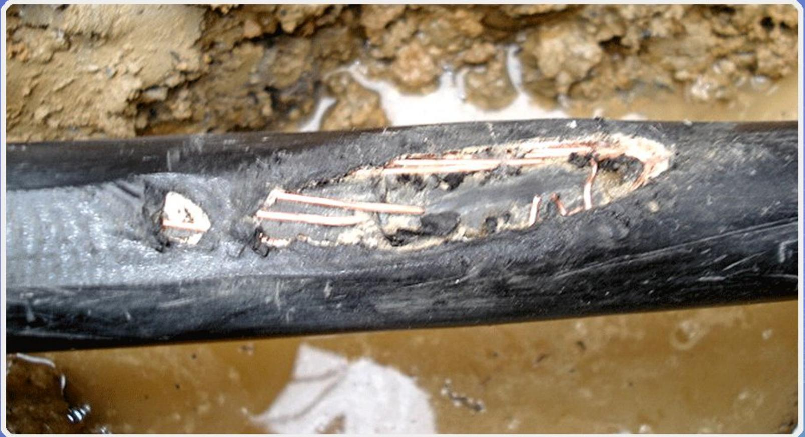
*Механическое повреждение — задир*
