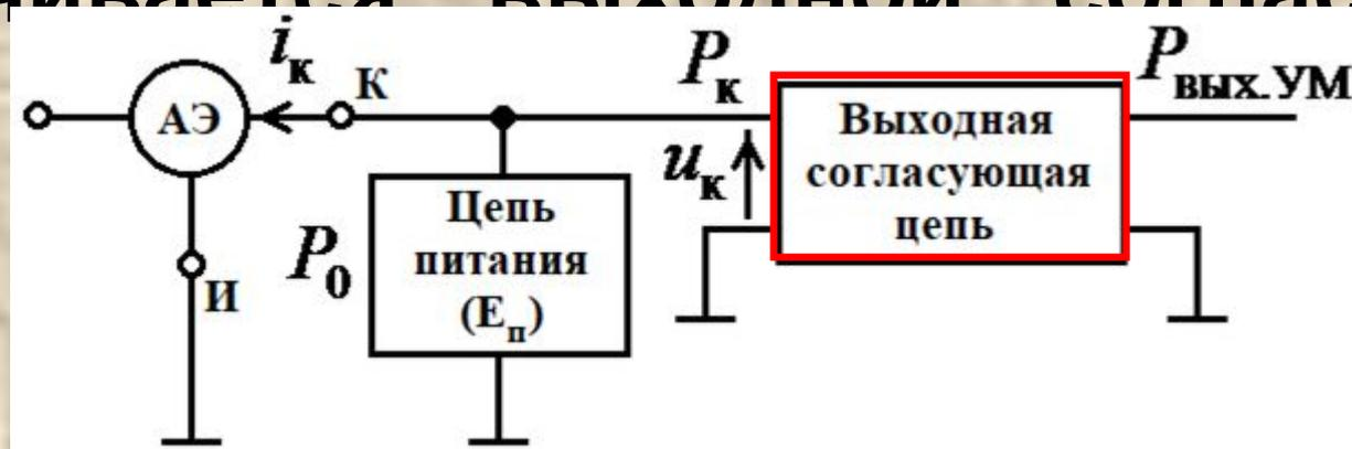
Для проведения анализа таких зависимостей необходимо проследить динамику изменения формы импульса коллекторного тока при изменении величины ощущаемой нагрузки  $R_K$ .
