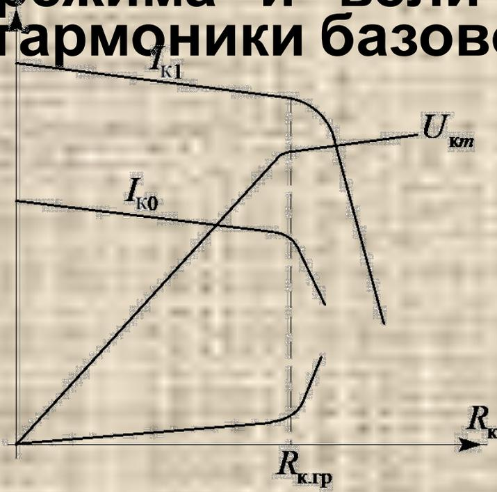
Слабая зависимость  $U_{кн}$  от  $R_k$  может быть использована при построении предварительного усилителя, работающего на изменяющуюся нагрузку, например, если нагрузкой является модулятор (осуществляющий
