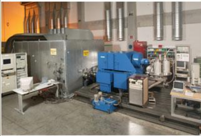
HTS генератор концерна Siemens
