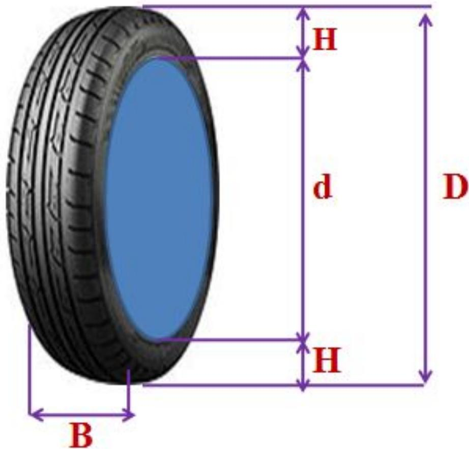
За обозначением типа конструкции шины идёт число, указывающее диаметр диска колеса в дюймах  $d$  (в одном дюйме 25,4 мм). По сути, это диаметр  $d$  (15) внутреннего отверстия в шине.
