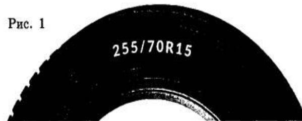
**Автомобильное колесо представляет из себя металлический диск с установленной на него резиновой шиной. Диаметр диска совпадает с диаметром внутреннего отверстия в шине.**
