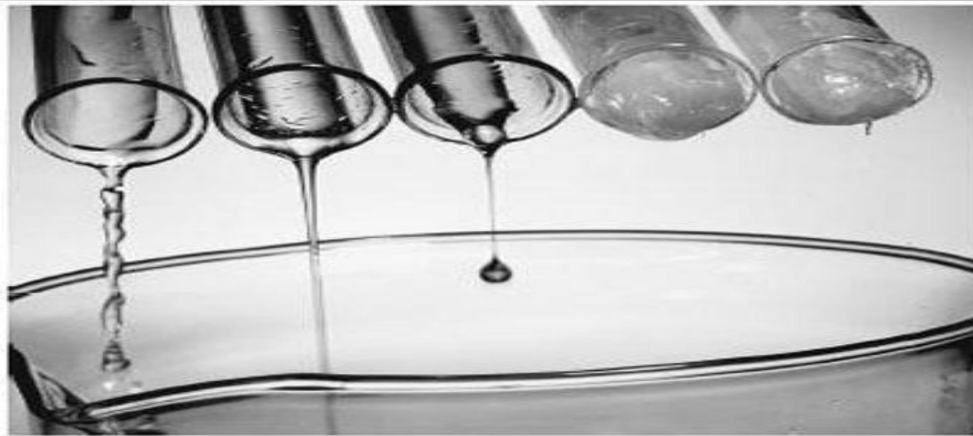
Вязкость жидкостей измеряют путем наблюдения за их течением в тонких трубках. В основе измерений лежит закон Пуазейля:
