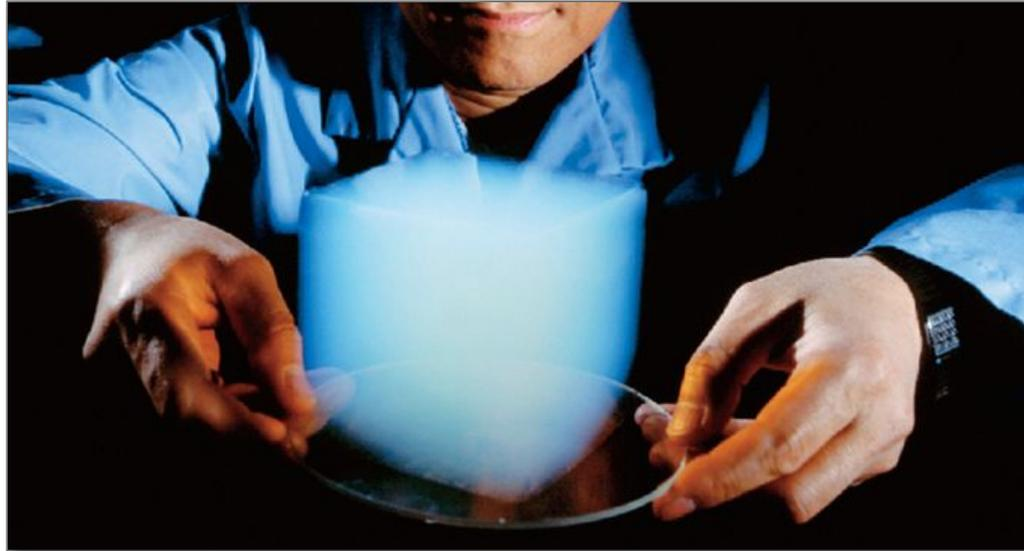
Con speciali procedimenti e ad alta temperatura, è possibile preparare un **aerogel**, un solido molto resistente e con bassissima densità, costituito da **aria e silice**.
