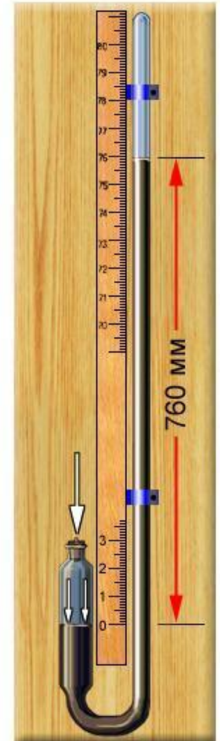
СХЕМАТИЧЕСКОЕ УСТРОЙСТВО РТУТНОГО БАРОМЕТРА
