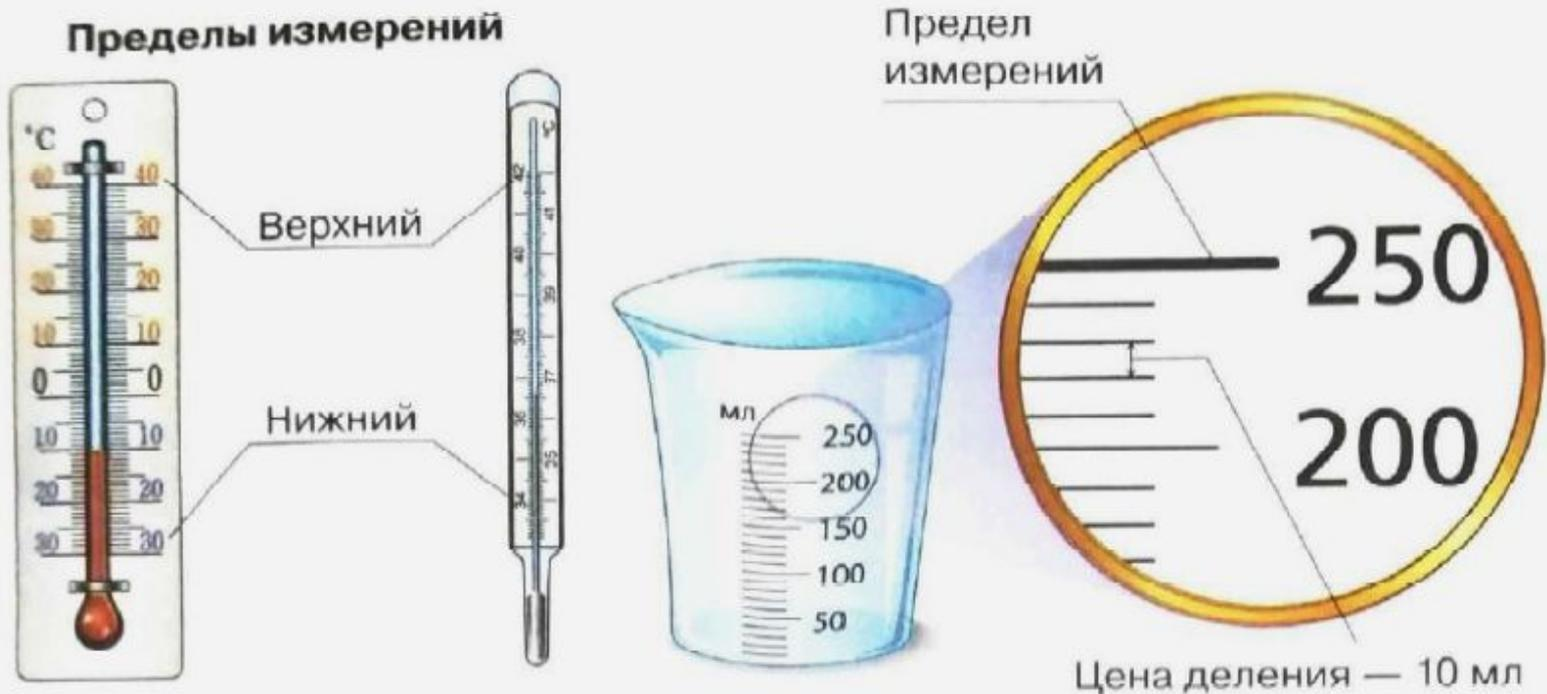
**Рис. 16.** Предел измерения и цена деления шкал измерительных приборов
