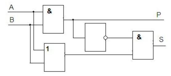
Чтобы убедиться в том, как работает схема, проследите за прохождением сигналов в каждом из четырёх случаев и составьте таблицу истинности данной логической схемы.
