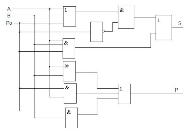
Сумматор - это электронная логическая схема, выполняющая суммирование двоичных чисел поразрядным сложением. Сумматор является центральным узлом арифметико-логического устройства процессора. Находит он применение и в других устройствах компьютера. В реальных электронных схемах сумматор изображается так:
