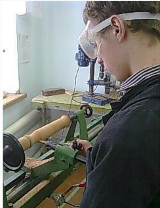
12. Работаю над фасонным точением, произвожу шлифование 2 части изделия.
