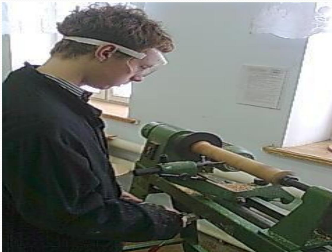
10. Делаю чистовую обработку заготовки.
