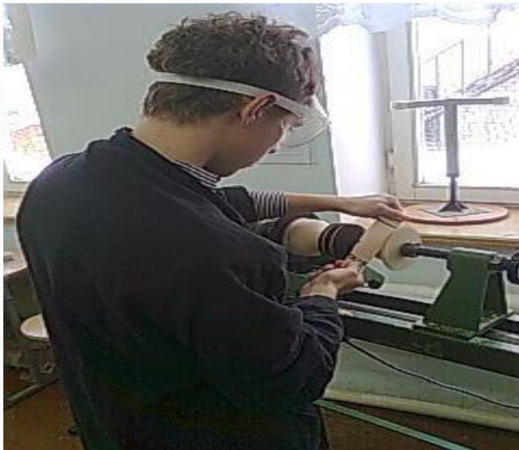
9. Беру заготовку из яблони размером 400мм\*65мм и устанавливаю ее в центрах токарного станка. Произвожу черновую обработку заготовки.
