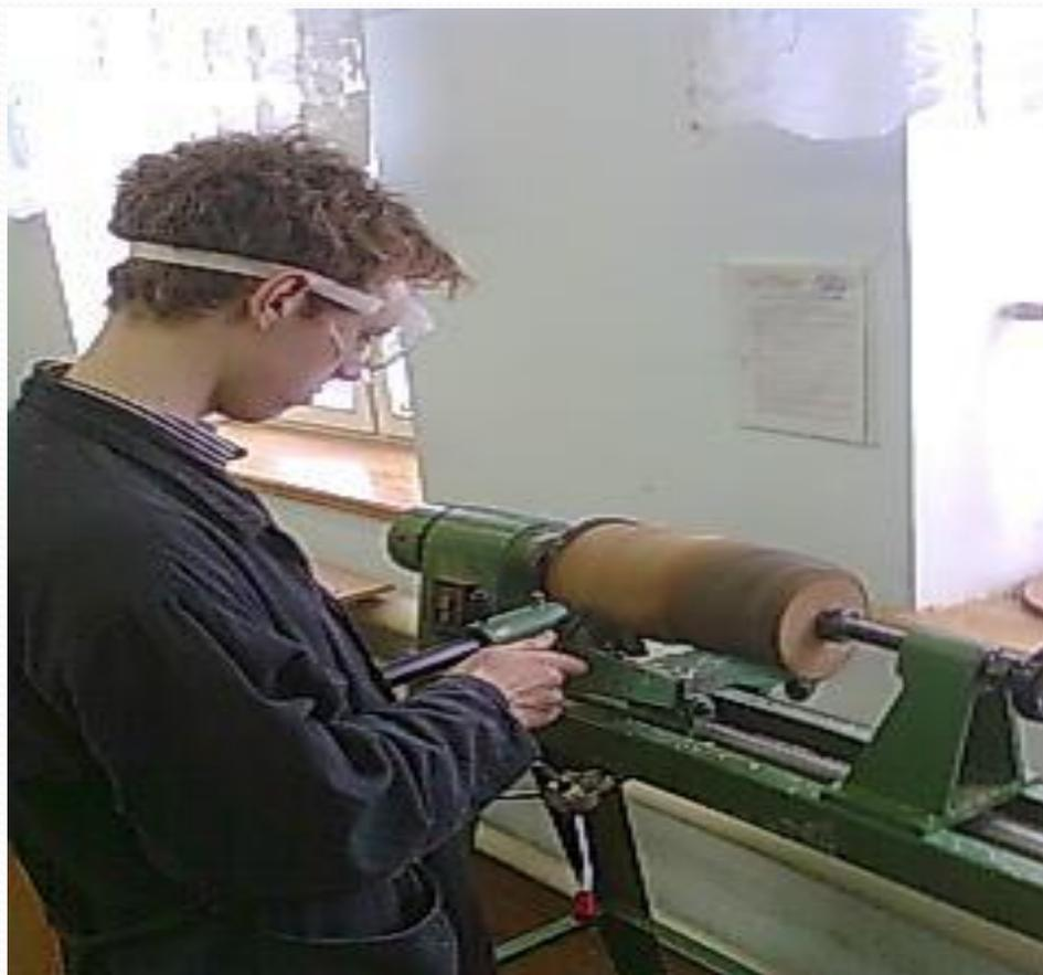
4.Затем перехожу к чистовому точению заготовки
