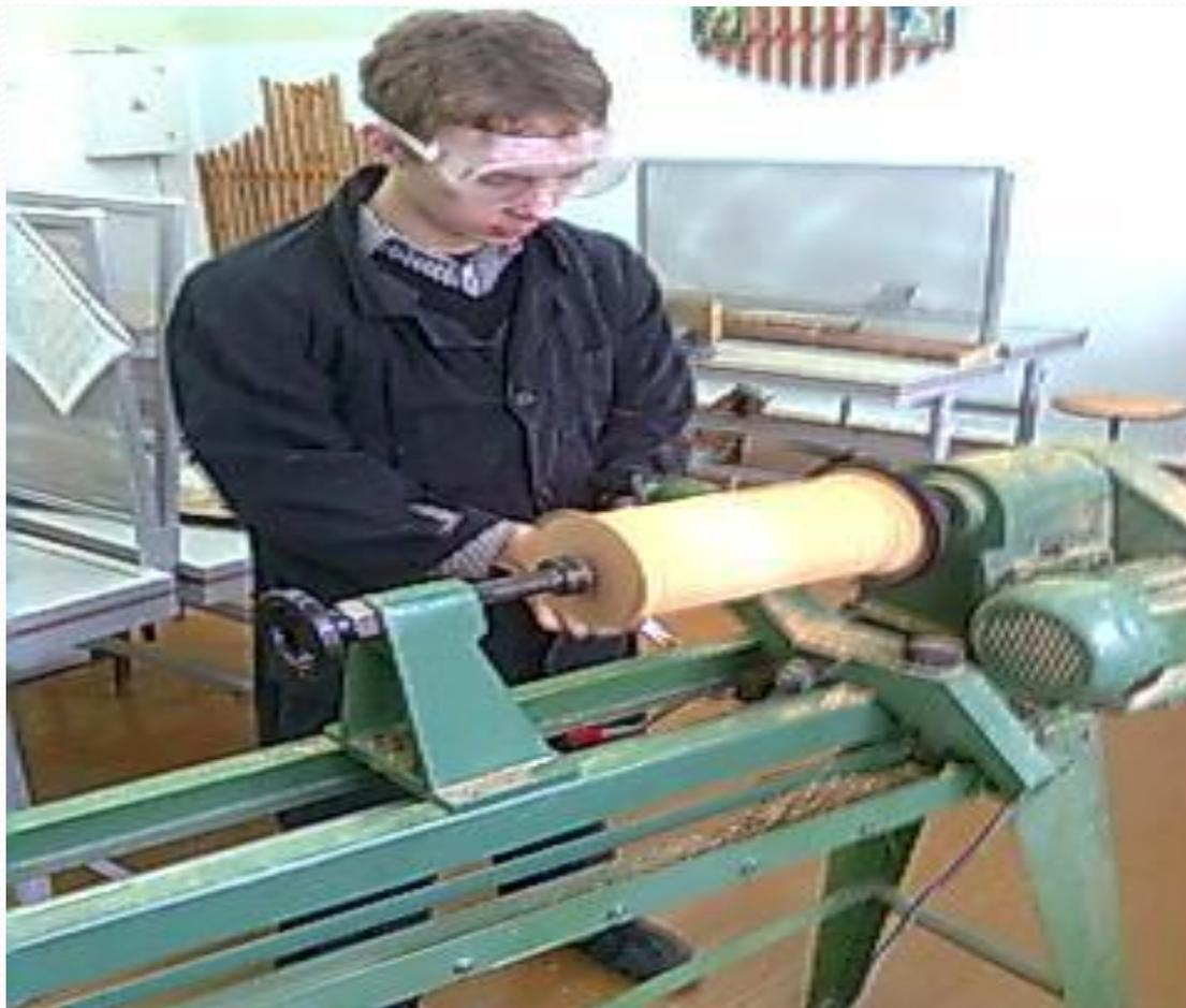
5. Работаю над коническим и фасонным точением заготовки и затем шлифую заготовку.
