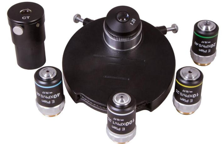
**Темнопольный конденсор.** При темнопольной микроскопии используют специальный конденсор с затемненной центральной частью, поэтому в плоскость изучаемого объекта идут только боковые лучи, отраженные от внутренних зеркальных поверхностей конденсора. Лучи света направлены под таким углом, что не попадают в линзу объектива, и поэтому поле зрения выглядит темным. Часть лучей, которые попадают на объект, отражается в линзу объектива, благодаря чему на темном фоне видно светлое изображение объекта.
