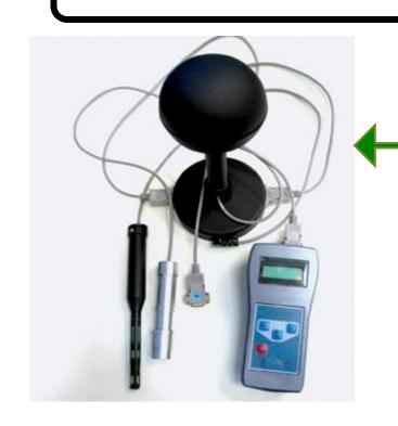
Метеометр МЭС-200А, предназначен для измерения атмосферного давления, относительной влажности воздуха, температуры воздуха, скорости воздушного потока внутри помещения или в вентиляционных трубопроводах, параметров тепловой нагрузки среды ТНС-индекса и концентрации токсичных газов
