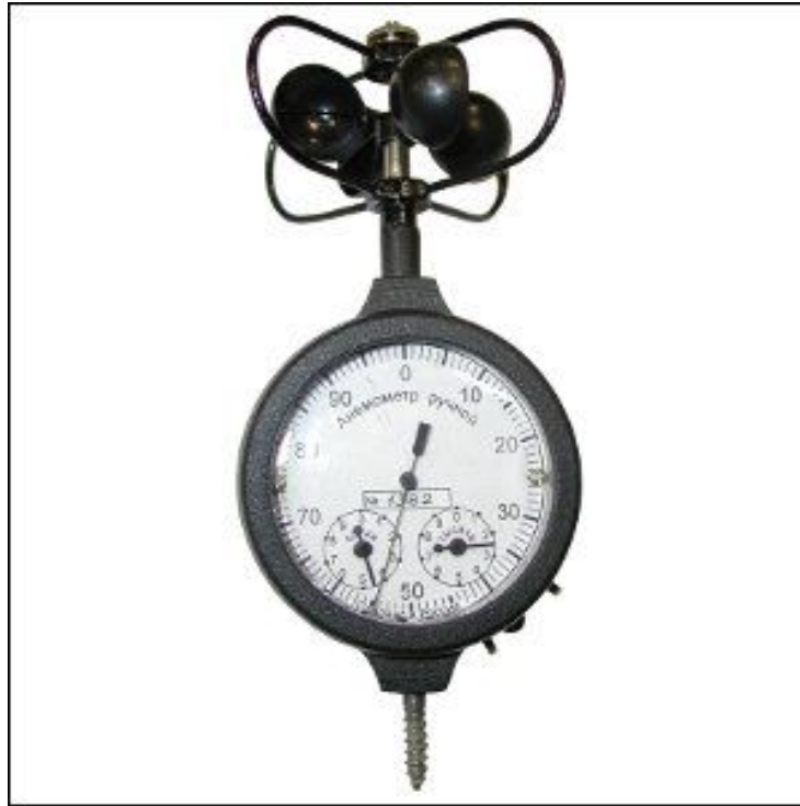
Анемометр ручной чашечный – определение скорости ветра
