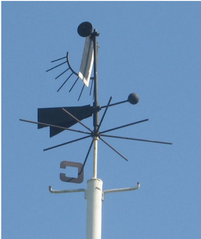
Флюгер стационарный (Вильда) – определение направления ветра в приземном слое
