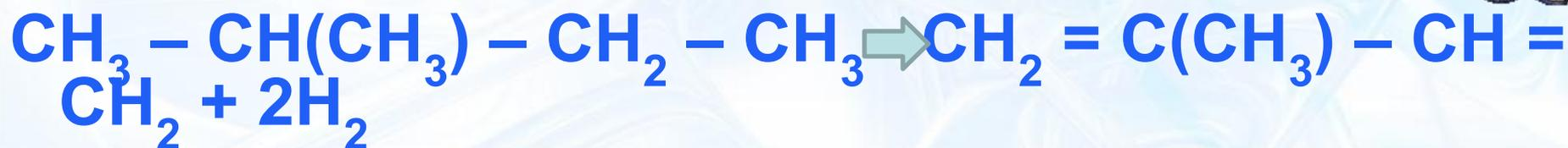
Каталитическим дегидрированием изопентана (2-метилбутана) получают изопрен.
