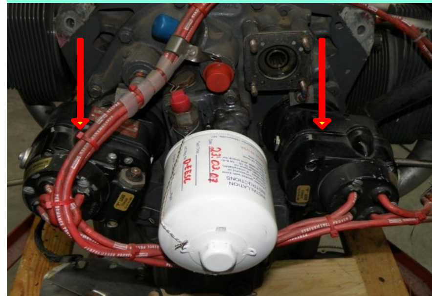
Рис. 16. Магнето, привода магнето, проводка и свечи зажигания
