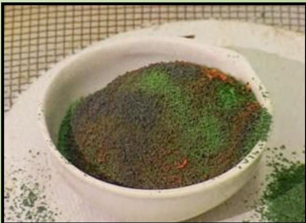
Окисление этилового спирта кислородом воздуха происходит очень легко в присутствии оксида хрома (III). В фарфоровую чашку поместим кусочек ваты, смоченный спиртом. Подождем вату. Осторожно насыпаем на горящую вату оксид хрома. Пламя гаснет. Но оксид хрома начинает раскаляться. Реакция окисления спирта протекает с выделением энергии. Продукт реакции окисления спирта - уксусный альдегид.
