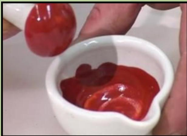
Приготовим трубку для определения алкоголя. Для этого разотрем в ступке хромовый ангидрид (оксид хрома (VI)) с небольшим количеством серной кислоты. Получается паста красного цвета. Нанесем пастой полосу на стенках трубки. Трубку соединим с прибором, подающим смесь воздуха с парами этилового спирта. Через некоторое время красная полоса в трубке зеленеет. Спирт окисляется в уксусный альдегид, а окислитель оксид хрома превращается в сульфат хрома (III), имеющий зеленую окраску.
