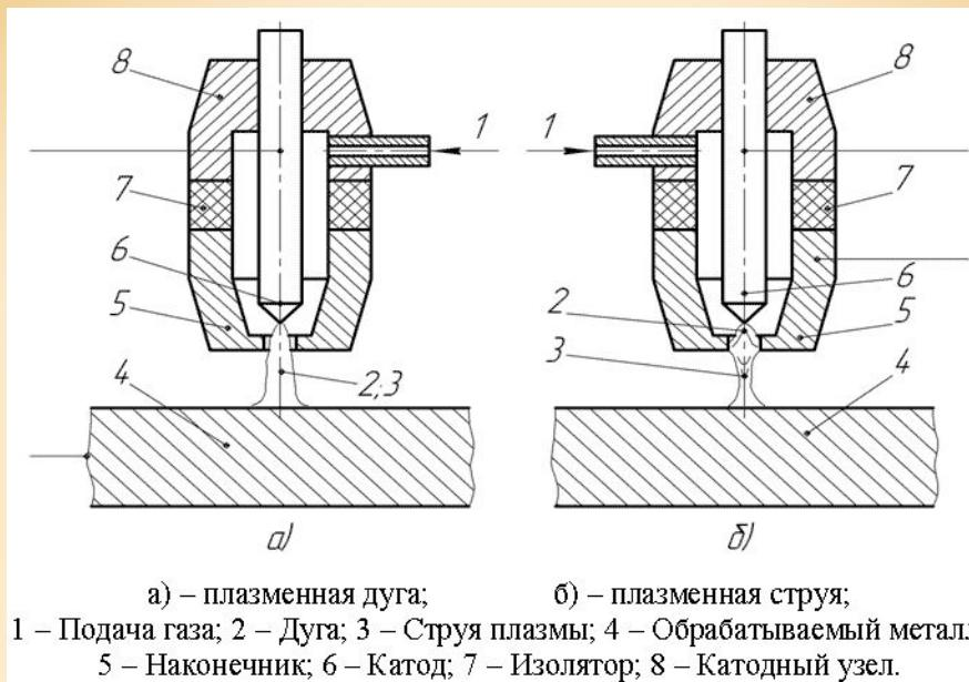
\*Толщина разрезаемого металла может доходить до 200 мм. Первоначальное зажигание дуги осуществляется высоковольтным импульсом или коротким замыканием между анодом и катодом в случае косвенной дуги, и форсункой и разрезаемым металлом в случае прямой дуги. Форсунки охлаждаются потоком газа (воздушное охлаждение) или жидкостным охлаждением. Воздушные форсунки как правило надежнее, форсунки с жидкостным охлаждением используются в установках большой мощности и дают лучшее качество обработки.
