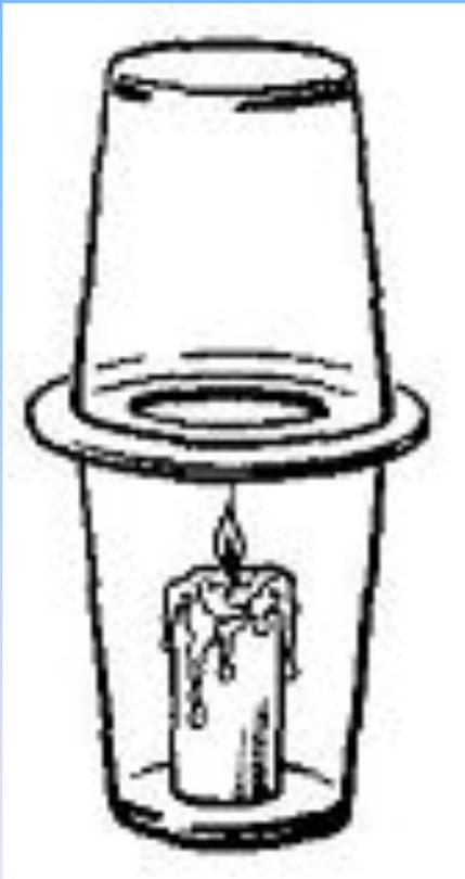
**Вывод:** При горении воздух нагревается. После закрытия одного стакана другим, процесс горения прекращается. Воздух начинает охлаждаться. Внутри стаканов возникает разрежение, благодаря которому они прижимаются атмосферным давлением к бумаге.
