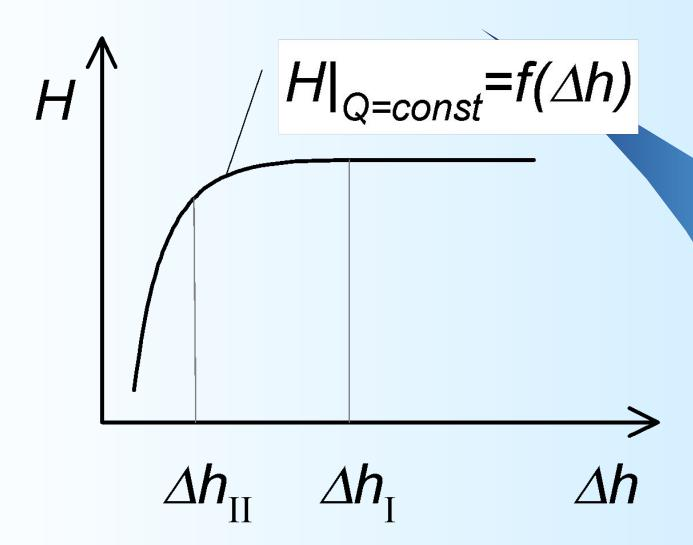
Режим работы насоса, когда при неизменной подаче начинается падение напора, называют первым критическим режимом. Ему соответствует первый критический кавитационный запас  $\Delta h_{\mathsf{I}}$
