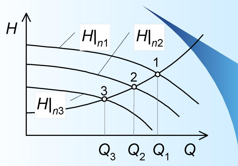
Рассматриваемый способ регулирования не вызывает дополнительных потерь энергии, поскольку напор в сети соответствует напору, развиваемому насосом.
