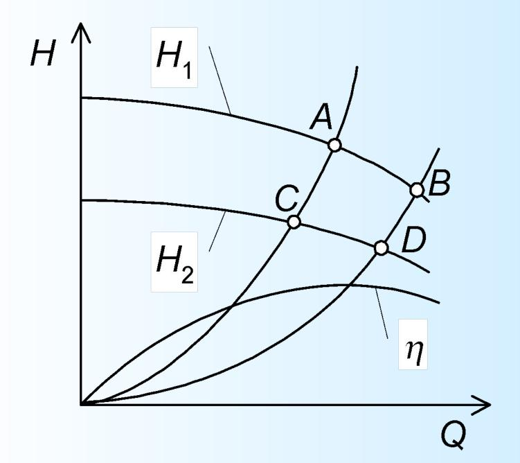
Предположим, что линия  $H_1$  представляет собой характеристику необточенного колеса, а  $H_2$  – характеристику при максимальной обточке колеса. Участок А-В характеристики является рабочим, т.е. соответствует максимальному КПД. Точки C и D построены с помощью парабол обточек и ограничивают оптимальную рабочую зону максимально обточенного колеса.
