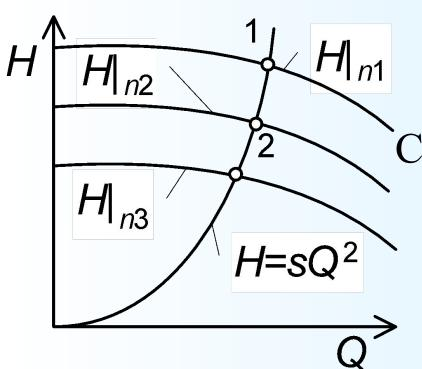
Соединив полученные точки плавной линией, получим искомую кривую подобных режимов.
