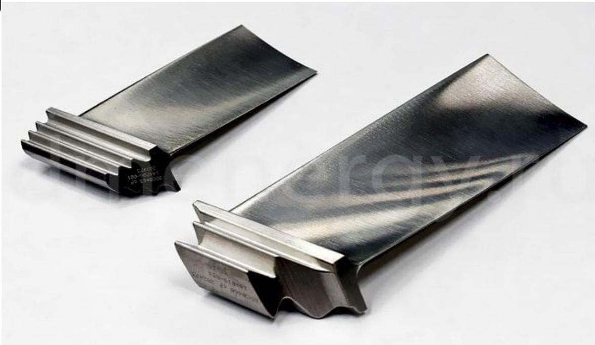
Лопатки изготавливаются литьем из заготовок. Заготовки лопатки состоят из пера и хвостовика. Затем, при помощи механической обработки, лопатке придается окончательная форма и профиль. К перу лопатки предъявляются высокие требования с точки зрения геометрической формы и шероховатости поверхности. Лопатки различных ступеней компрессора изготавливаются из различных материалов.
