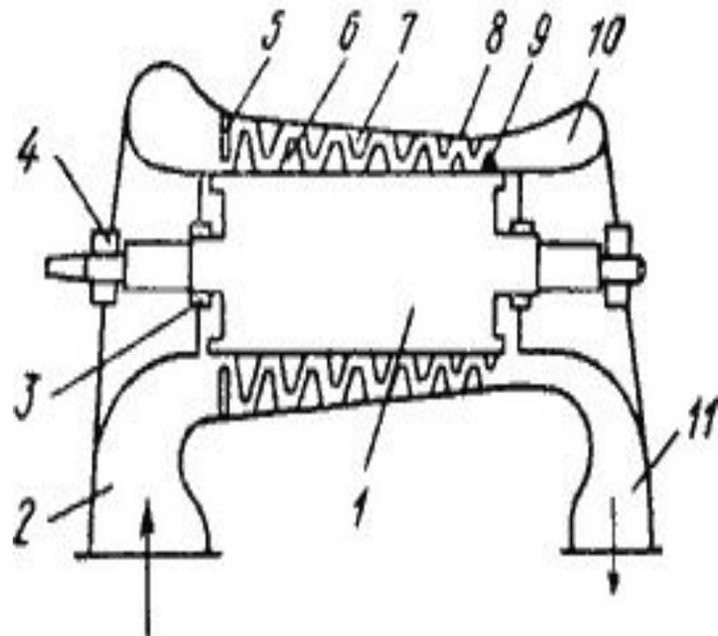
Таким образом, осевой компрессор по своему устройству напоминает реактивную турбину. Воздух в компрессор засасывается через входной **патрубок 2**, проходит через направляющий **аппарат 5**, сжимается в направляющих и рабочих лопатках, поступает в **спрямляющий аппарат 9**, **диффузор 10** и выходит через **патрубок 11**.
