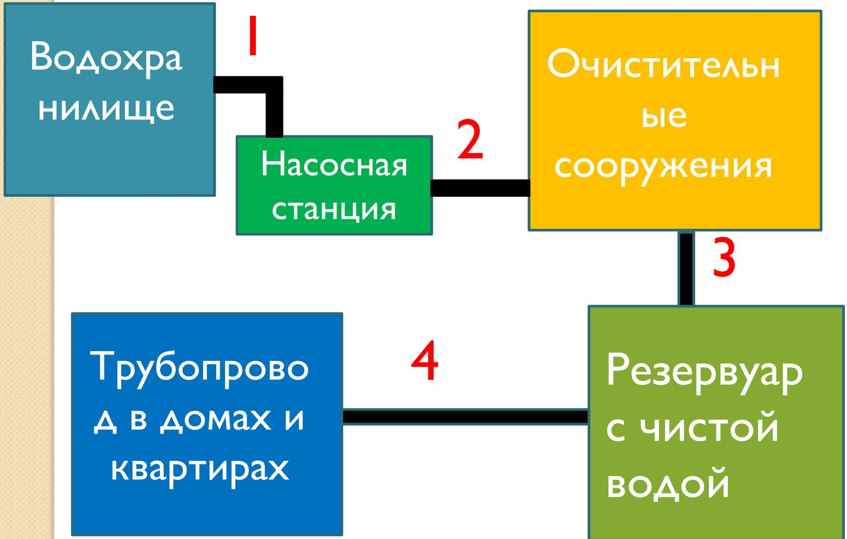
*Для монтажа водопровода внутри домов и квартир используют **СТАЛЬНЫЕ ТРУБЫ** с цинковым покрытием внутри и снаружи*
