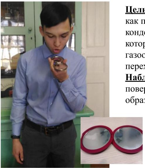
**Цель опыта**: посмотреть, как происходит конденсация (явление, при котором вещество из газообразного состояния переходит в жидкое) **Наблюдения:** На поверхности зеркальца образуются капельки воды.
