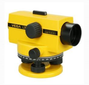
Оптический нивелир Vega - для производства нивелирования в самых различных отраслях строительства и геодезии. Автоматический компенсатор с магнитным демпфером самостоятельно контролирует состояние оси прибора, при необходимости корректируя ее.
