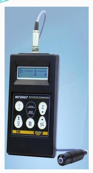
Магнитный толщиномер покрытий МТ-2007 предназначен для измерения толщины лакокрасочных, гальванических, огнезащитных и любых других немагнитных токопроводящих и непроводящих покрытий на ферромагнитных (сталь, чугун и пр.) основаниях.
