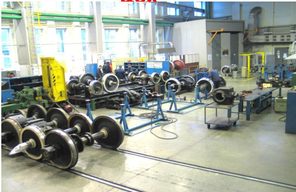
Колесно-тележечный цех аттестован для проведения полного освидетельствования колесных пар без смены элементов всех типов СПС,
