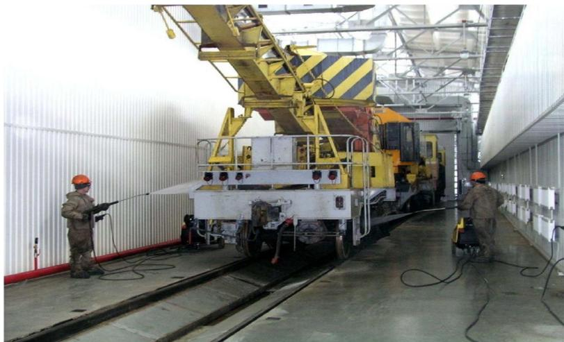
**Назначение:** Очистка, мойка железнодорожно- строительных машин.
