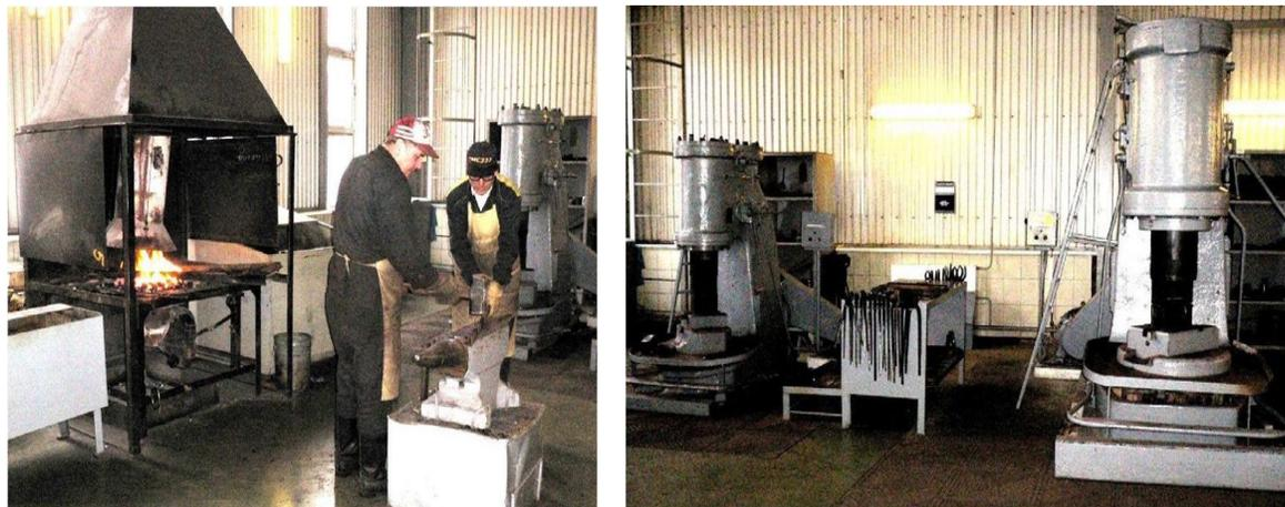
**Назначение:** Изготовление заготовок для механического цеха, методомковки, выполнение кузнечнопрессовых работ различной потребности (правка, гибка).
