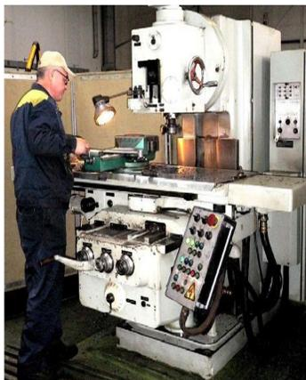
**Назначение:** Изготовление и восстановление деталей для ремонта путевых машин.
