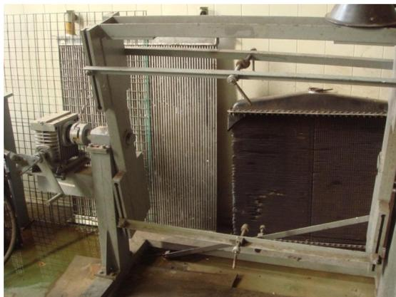
**Назначение:** Ремонт радиаторов охлаждения двигателей путевых машин.
