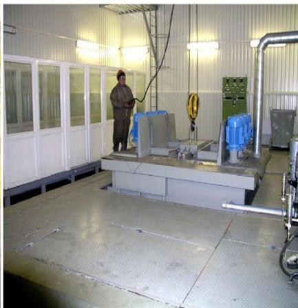
**Назначение:** Ремонт путевых машин, ремонт и испытание редукторов всех типов, роликов, транспортерных лент.
