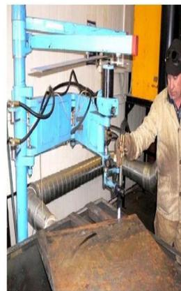
**Назначение:** Восстановление узлов и деталей сваркой и наплавкой, газовая резка металла по копиру.
