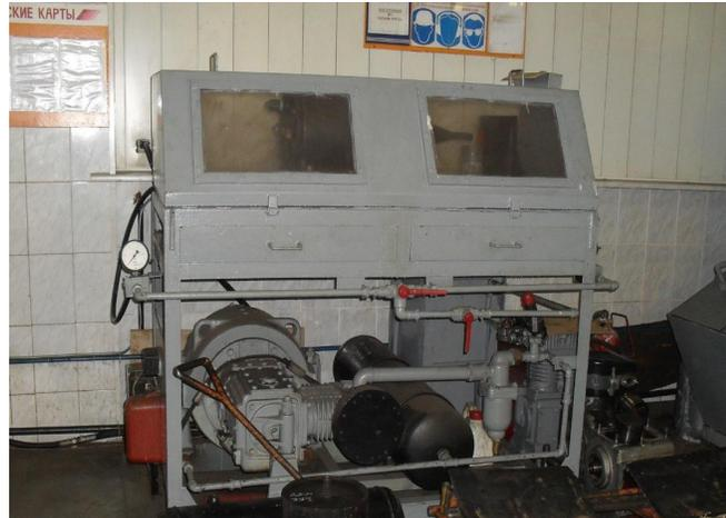
**Предназначен для ремонта автотормозного оборудования и оборудования пневматической системы СПС.**
