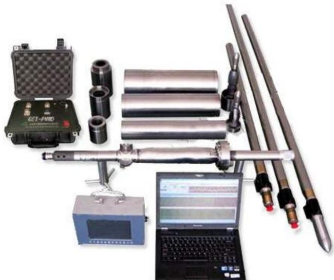
孔内分布式地震电法仪
