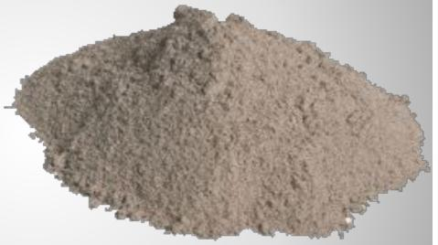
Используется для производства огнеупорного кирпича, необходимого для строительства доменных печей. Огнеупорный кирпич Семилукского завода выдерживает температуру до 1700°C.
