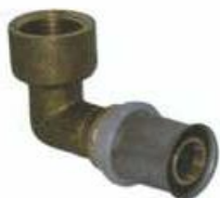
Угольник с внутренней резьбой (переход на трубную арматуру) 16×1/2; 20×1/2; 20×3/4; 26×1; 32×1
