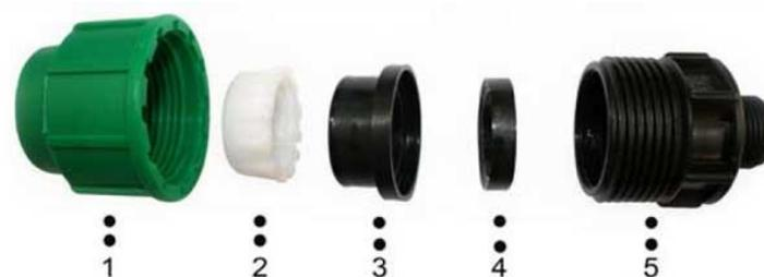
Рис. 1. Конструкция компрессионного фитинга (муфта, колена, тройник и т.п.): 1 – зажимная гайка; 2 – зажимное кольцо (цанга); 3 – компрессионное (упорное) кольцо; 4 – уплотнительное кольцо; 5 – основной корпус
