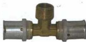
Тройник с наружной резьбой (переход на трубную арматуру) 16×1/2; 20×1/2; 20×3/4; 26×1; 32×1
